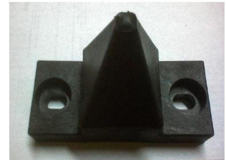
CENTRADOR DE PUENTE GRUA, PLANTA EW EN PE
