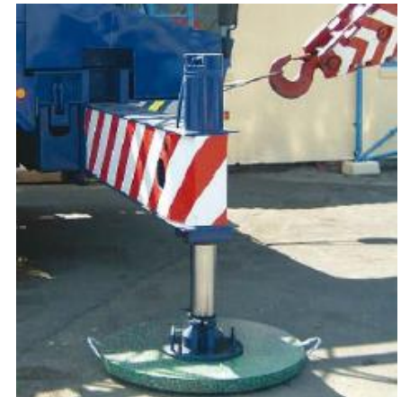
SOPORTES GRUAS EN PE
